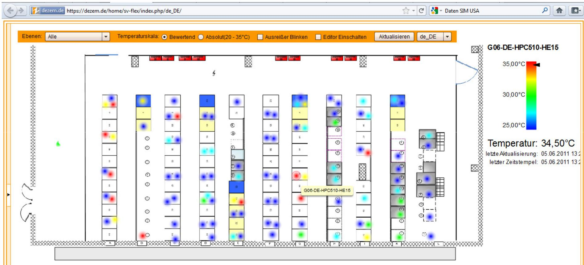
Mit deZem IPCs und miniaturisierten, busfähigen Sensoren, lässt sich die **Überwachung von Temperaturen, Strömen, Differenzdrücken, Feuchten, etc.** elegant realisieren – in Echtzeit und historisch.
